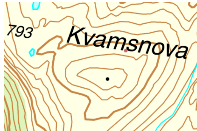
Terrengpunkt med høydetall
